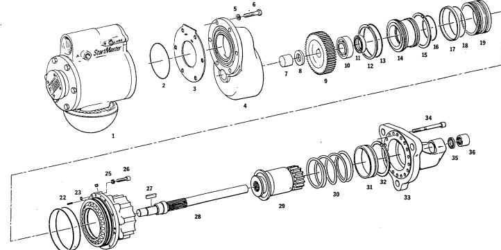
STARTMASTER 250 DRIVE ASSEMBLY FOLD-OUT NO. 1
